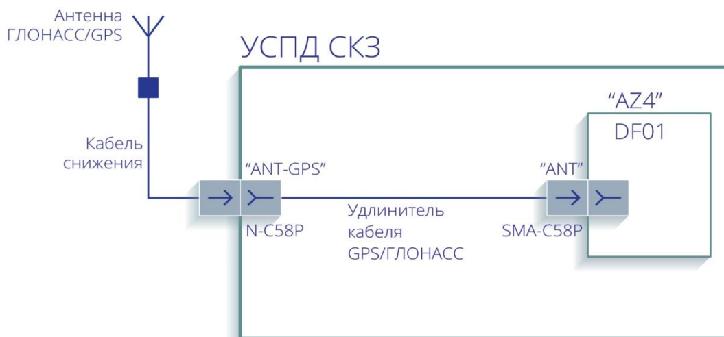
Рисунок 28 - Схема подключения антенны GPS/ГЛОНАСС
