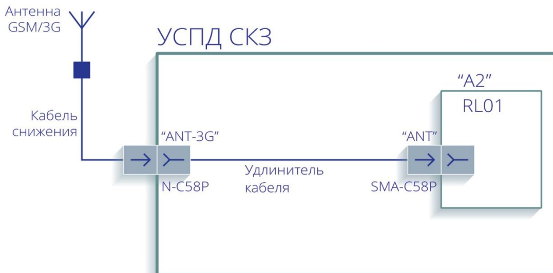
Рисунок 29 - Схема подключения антенны к GSM/3G-роутеру
