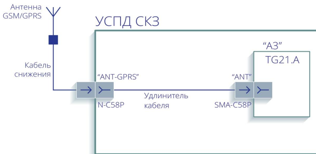
Рисунок 30 - Схема подключения антенны к GSM/GPRS-модему
