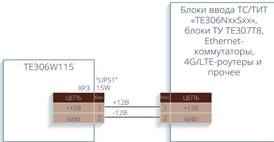
Рисунок 28.2 – Подключение цепей нагрузки =12В к блокам питания TE306W115
