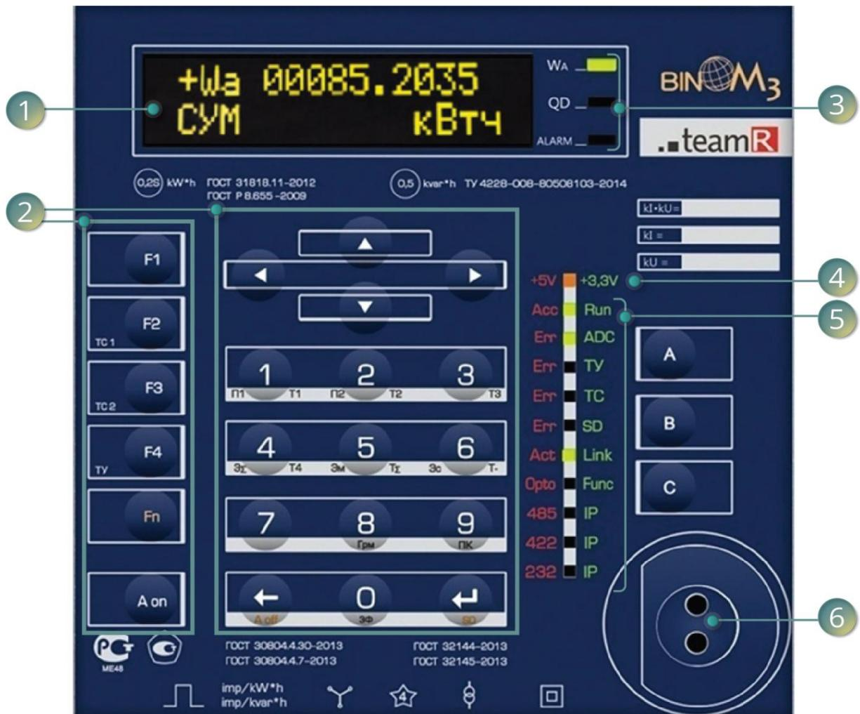
Рисунок 35 – Лицевая панель счетчика «BINOM3»
