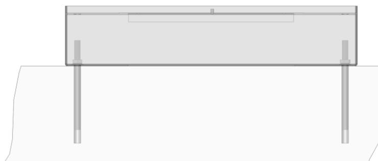
Рисунок 56 - Крепление шкафа к полу
