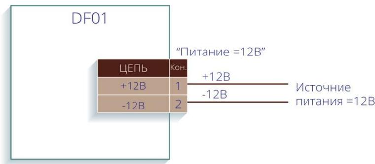
Рисунок 17 - Схема подключения внешнего источника питания =12В к модулю «DF01»
