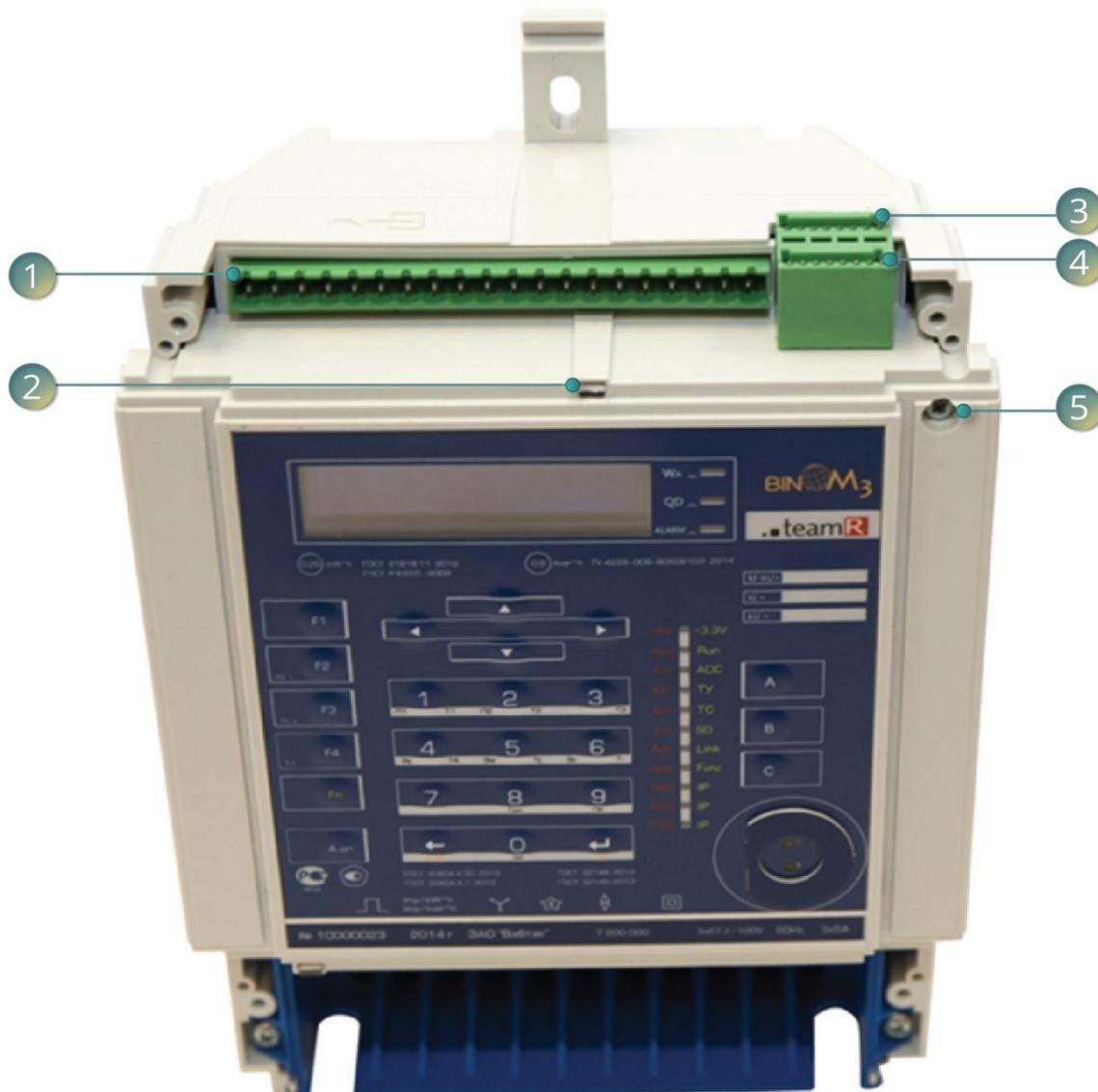
Рисунок 33.1 - Разъемы счетчика. Вид сверху.
